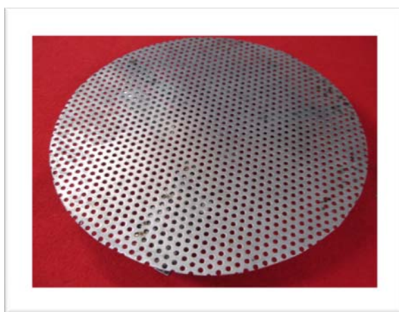
شکل ۲- استفاده از صفحه جدا کننده در بیوراکتور برای کاهش شیشه‌ای شدن ریز نمونه‌ها
