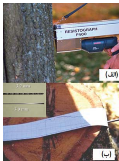
شکل ۱- پایش وضعیت تنه درخت بوسیله روش مقاومت نگاری الف) دستگاه مقاومت نگار (رزیزتوگراف) ب) نوار گراف تغییرات سختی چوب در مسیر ورود مته به درون تنه
